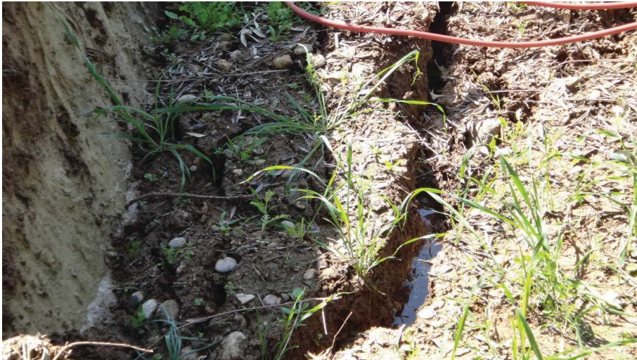
Şekil 6. Heyelan kütlesi içinde su varlığının görünümü.
